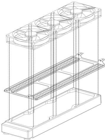
→ Vergewissern Sie sich, dass Sie die Lüfter über der Halterung installieren.
