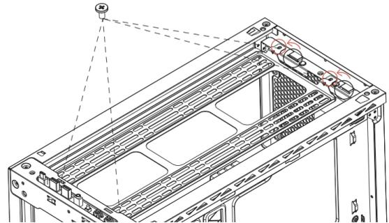
3. DRAM的建議高度低於45mm (如右圖標示)。建議安裝風扇與水冷排時，先安裝風扇在支架上方、水冷排安裝在支架下方，並靠左側玻璃方向安裝，增加水冷排和DRAM的距離。
