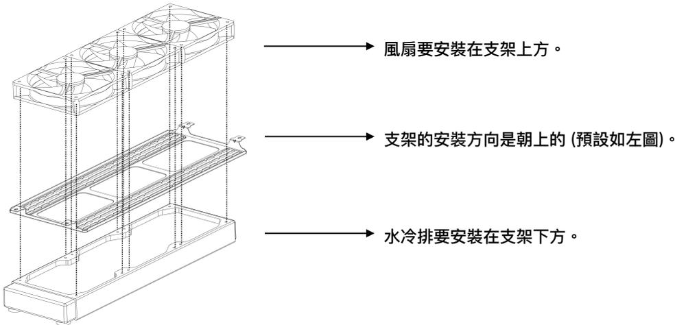
2. XPG BATTLECRUISER 機殼的上排支架是可以拆解的。請先卸下四個螺絲後，支架靠左側玻璃邊安裝並牢固鎖緊螺絲。
